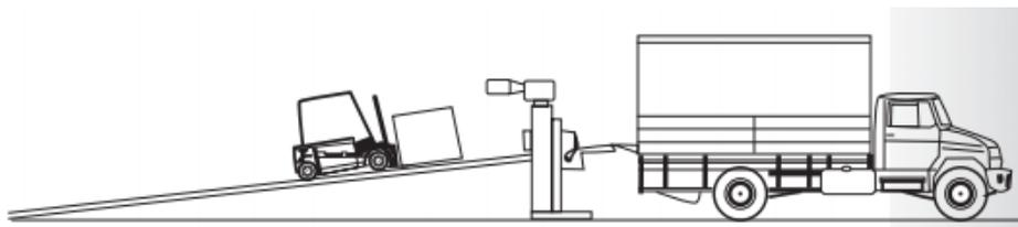
Платформа уравнильная (далее платформа) предназначена для обеспечения въезда-выезда в грузовой автофургон или стандартный морской контейнер, установленный на автомобильной платформе автопогрузчика для обеспечения разгрузки комплектующих, а также обеспечение выгрузки с автомобильной платформы самоходного шасси своим ходом.
