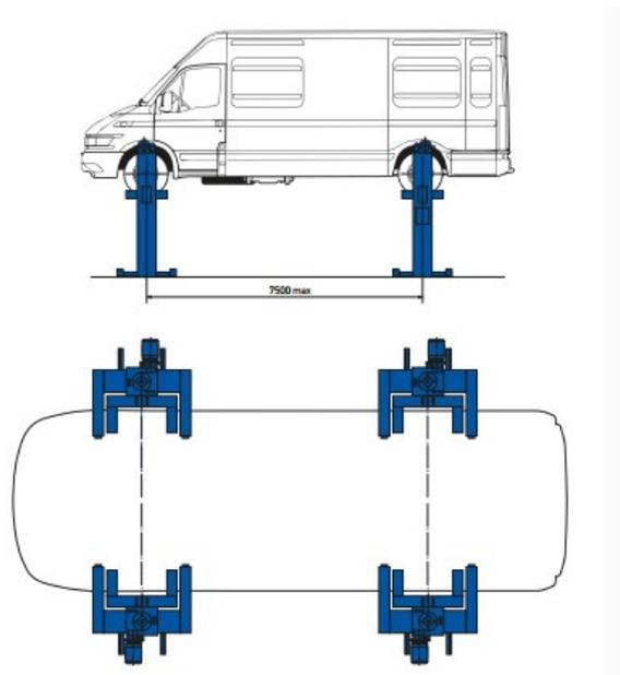
Подъемник четырехстоечный, подкатной с электромеханическим приводом предназначен для вывешивания легковых автомобилей собственной массой до 6т при выполнении их технического обслуживания и ремонта. Подхват автомобиля производится за колеса.
